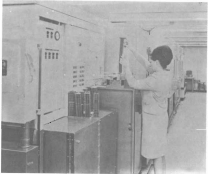
Figura 10 - Sistema automatico per la misura e la selezione di circuiti integrati.
